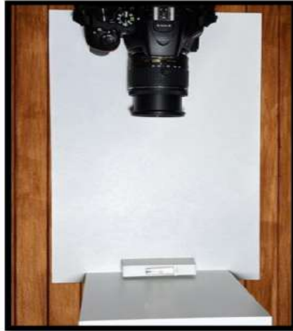
Figura 1. Bloque de resina acrílica con conducto simulado curvo (30°–35°) previo a la instrumentación.
